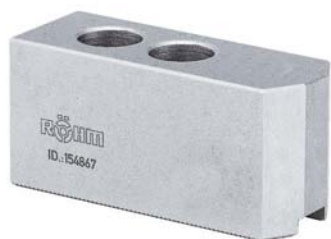
Picado 60°: Juego de 3 garras blandas, pueden ser endurecidas, material 16 MnCr 5
